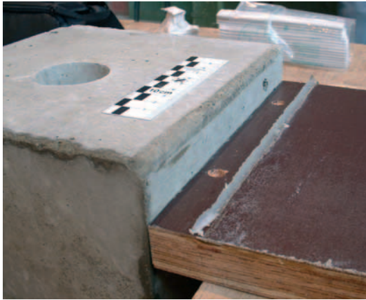
Ergebnisse eines Workshops: mit Silikon dick ausgerundete Kante mit deutlichen Farbveränderungen
