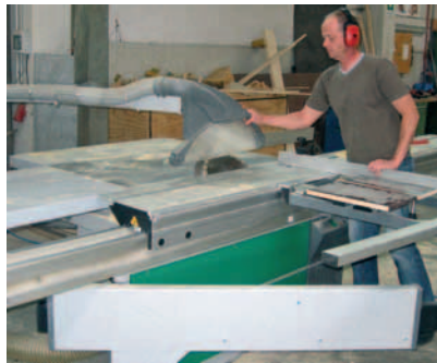
Schalungsbau mit großer Formatkreissäge
